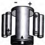
**F Placer 6 piles de type AAA en veillant à respecter la polarité des piles et des bornes.**
